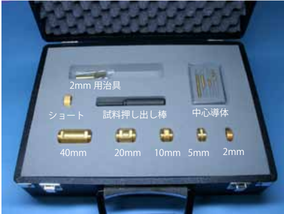
CSH2-APC7 キット内容
