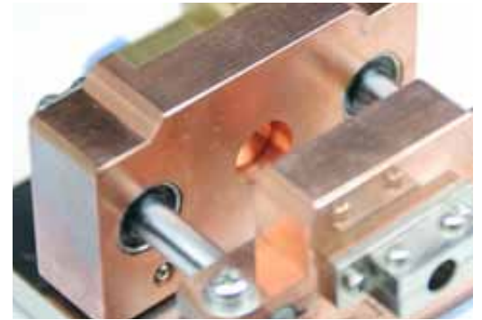
空洞部分拡大 ノックピンでしっかり試料に密着する
